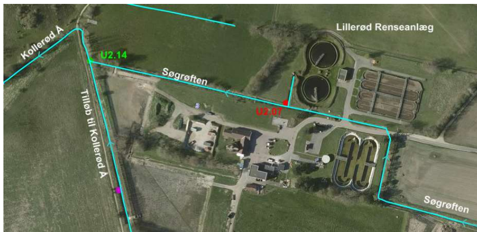
Figur 1: U2.14 angiver det punkt hvor Søgrøften udleder til tilløb til Kollerød Å. U2.07 angiver det punkt hvor Lillerød Renseanlæg udleder rensed spildevand til Søgrøften.
